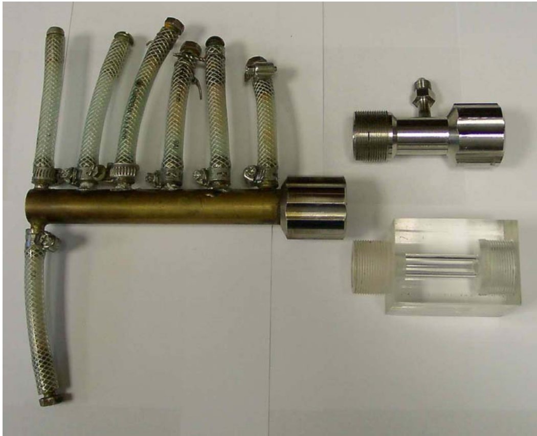
Рис. 1.9. Внешний вид сопла (слева) и цилиндрического канала – вставки между соплом и камерой смешения (справа), использованных в экспериментах автора.
