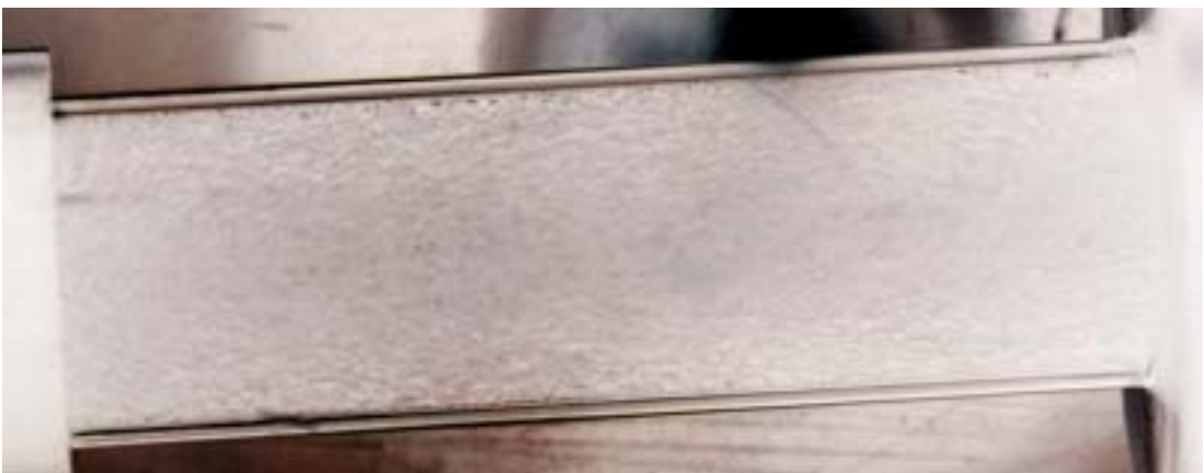
Рис.4.9. Фотографии потока на входе в сопло в свете вспышки продолжительностью 4 \cdot 10^{-4} с (негатив).
