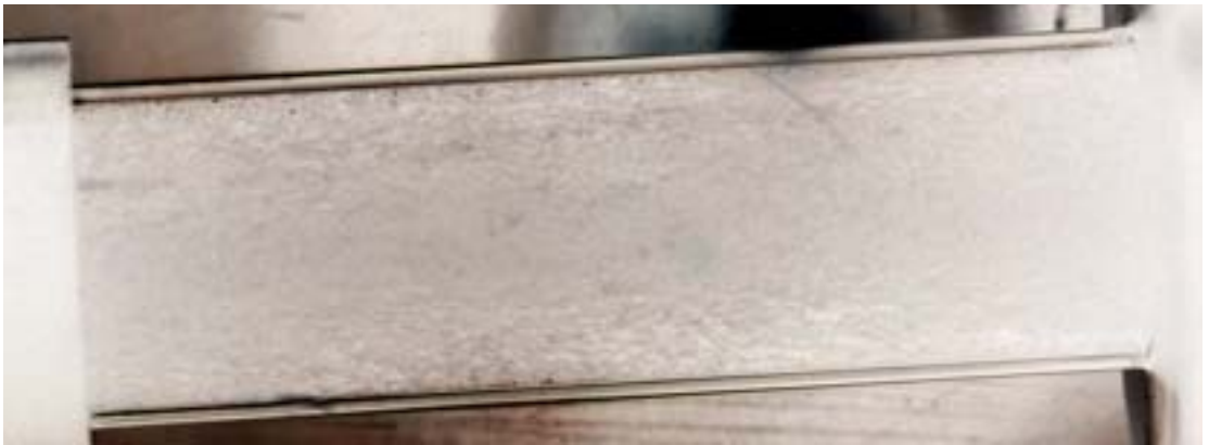
Рис.4.8. Фотографии потока на входе в сопло в свете вспышки продолжительностью 4 \cdot 10^{-4} с (негатив).
