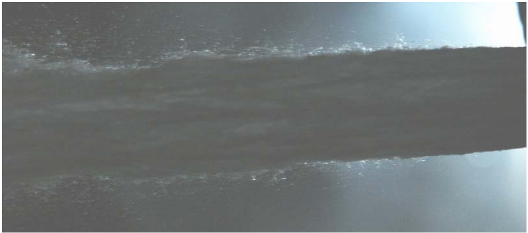
Рис.5.3. Фото струи «на просвет» у среза сопла (сопло справа) в свете вспышки 4 \cdot 10^{-4} с.
