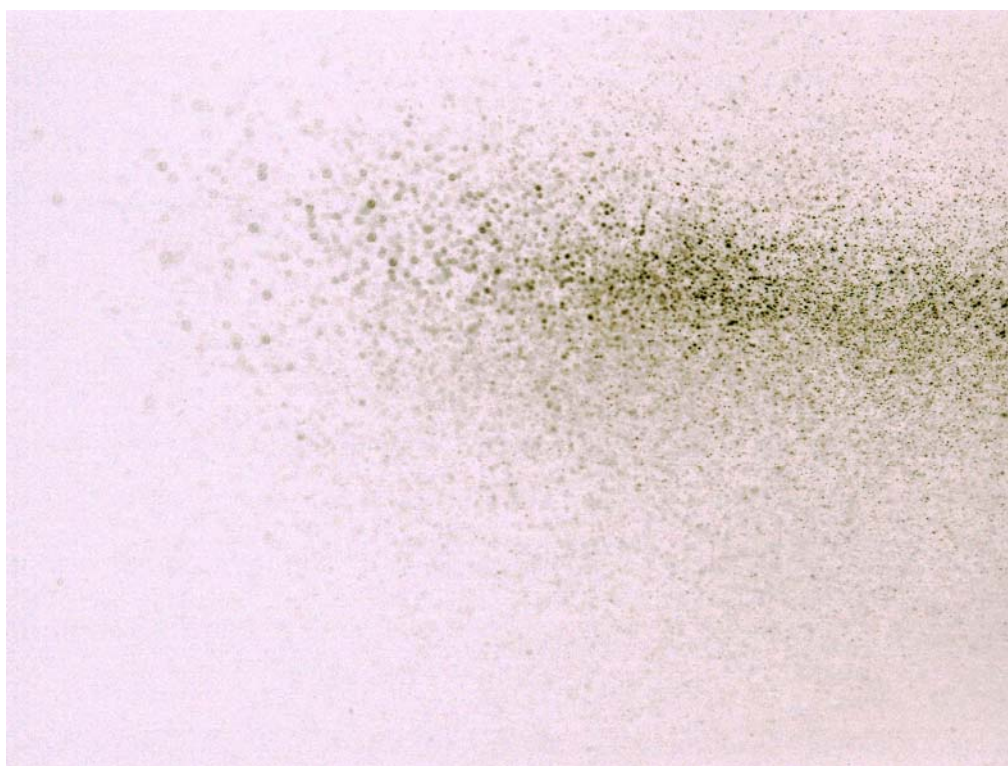
Рис. 5.19. Фото струи в свете вспышки продолжительностью 10^{-6} с в отраженном свете (сопло справа).
