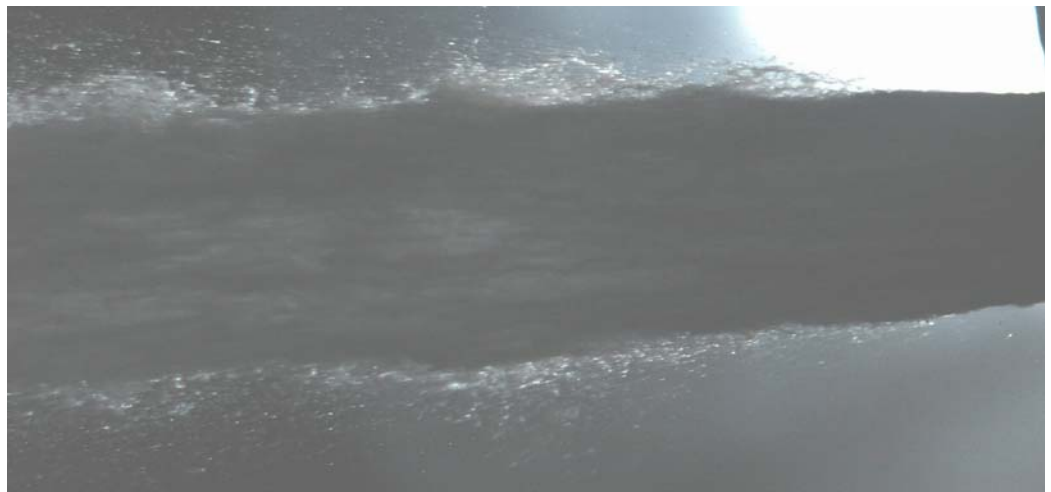
Рис.5.4. Фото струи «на просвет» у среза сопла (сопло справа) в свете вспышки 4 \cdot 10^{-4} с.
