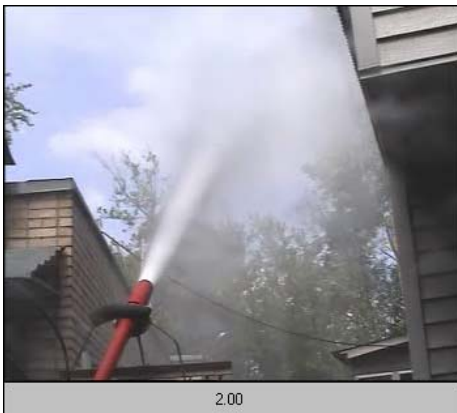
Рис. 7.15. Стендовые испытания установки пожаротушения вертолетного базирования.
