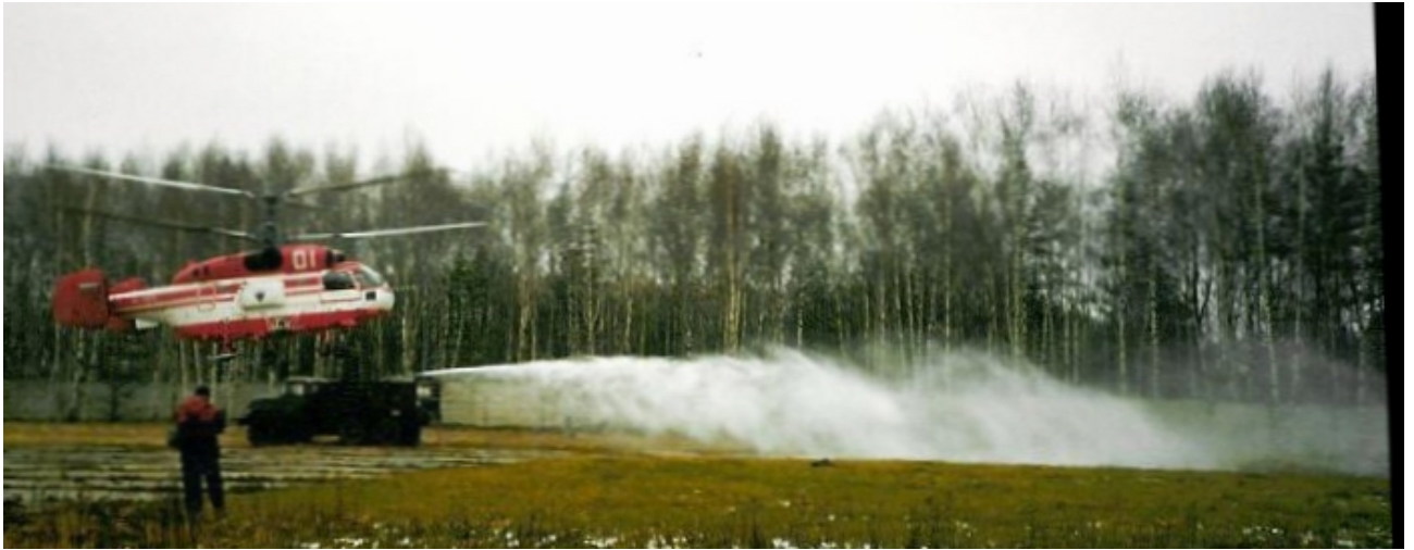
Рис.7.16. Наземные испытания установки пожаротушения вертолетного базирования.
