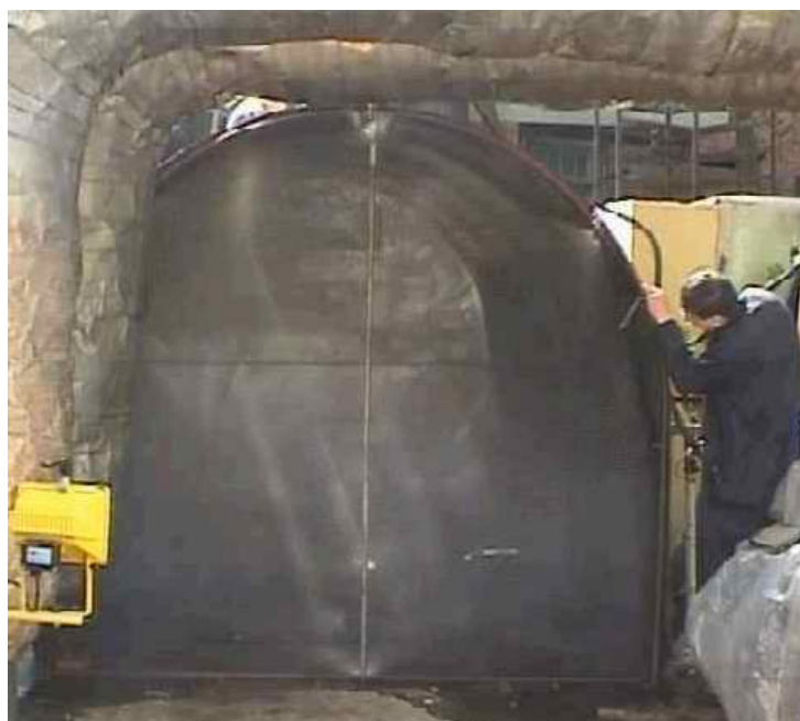
Рис.7.20. Эксперимент по задымлению в макете отсека воздушного судна. Видны работающие форсунки вверху и внизу макета, около вертикальной трубы.
