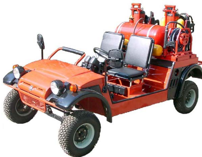
Рис.7.24. Дисперсная система с расходом 1 л/с и две РУПТ на мотоколяске «Кинешма».
