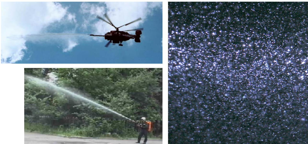
Рис.1. Ранцевая (внизу слева) и вертолетная (вверху слева) двухфазные системы пожаротушения. Справа – снимок струи недалеко от среза разгонного сопла; каждая «звездочка» - отразившая свет вспышки капля.
