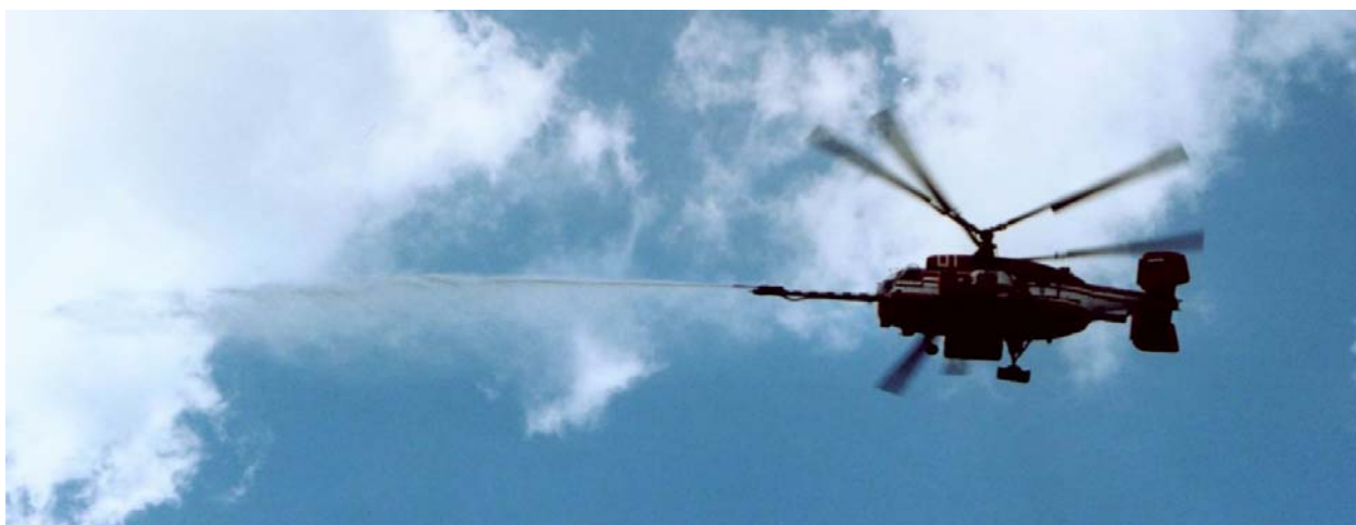
Рис. 4. Газодисперсная система пожаротушения НИИ НТ МАИ на вертолете Ка-32А.
