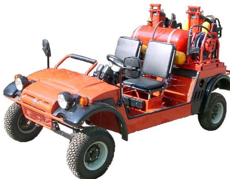
Рис.2. Газодисперсная система пожаротушения НИИ НТ МАИ на мотоколяске «Кинешма».
